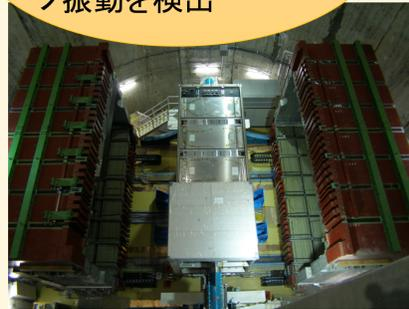
ND280検出器(off-axis) 振動前のニュートリノのフラックス、スペクトルを測定
