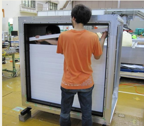
4.MPPCの取り付け+ケーブリング
