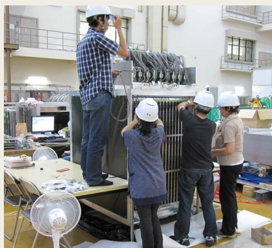
4.MPPCの取り付け+ケーブリング
