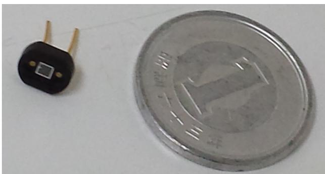
図 3.2: MPPC の写真 (大きさの比較のために 1 円玉を並べてある)
