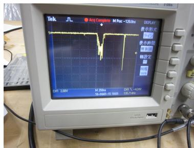
図 6.2: 上で言ったような場合のシンチ C の信号. 二つの信号の間隔が 500 ~ 1000ns 位になっているので, Stop1 のピークの位置 (600ns 付近) とも対応する.
