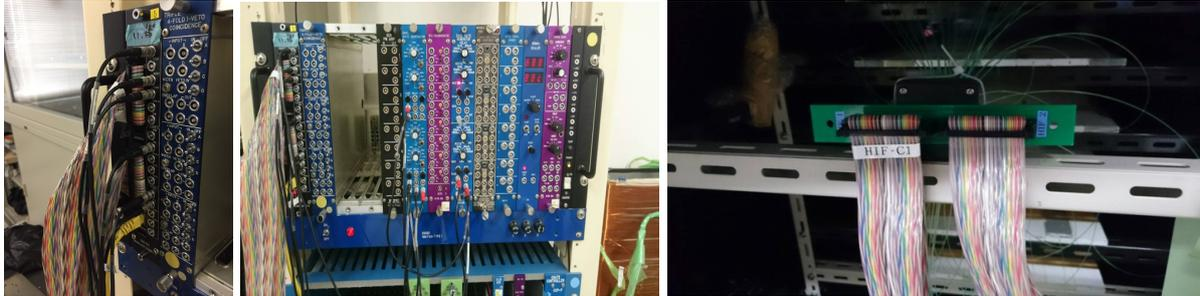
図4 EasirocModule(左:ケーブル、中:High Voltage、右:MPPC と接続されるケーブル)
