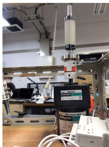
(B) モーターとローラー d の軸の結合
