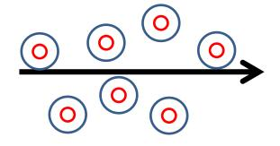
イオン化した粒子を凝結核として霧滴が生じ、 目で観測できる。
