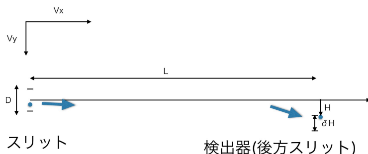
図9 セットアップと座標設定。上流スリットを通り抜けた中性子が下流スリットを通り抜けて検出器に入る様子を示している。
