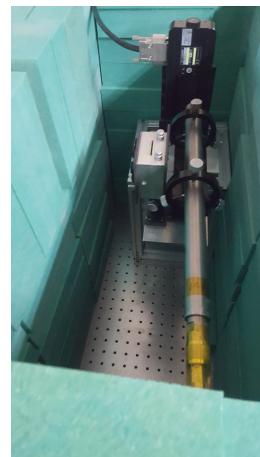
図8 ボロンブロック内の様子。円形のリングに固定されているものが今回の検出器である。
