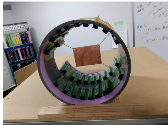
図 22: 磁場発生装置と標的 *1.
