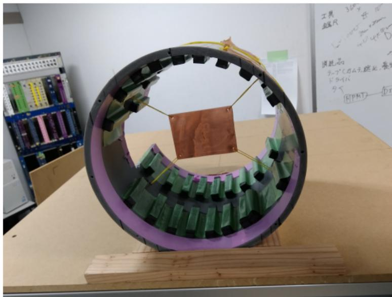
Figure: 磁場発生装置と標的
