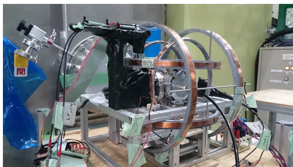
図 4.5 遮光シートで覆われたファイバートラッカーをレコフレームに設置した様子.
