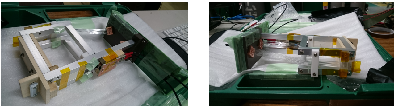
図 2.13 遮光シートを巻く前のファイバートラッカー。右の写真の手前側のファイバーが layer 1、奥側のファイバーが layer 2 である。finger 1 は遮光後に取り付けるためこの写真には写っていない。finger 2 は左の写真でアルミ棒にはさまっている白い直方体。上部に finger 2 の読み出し回路が写っている。
