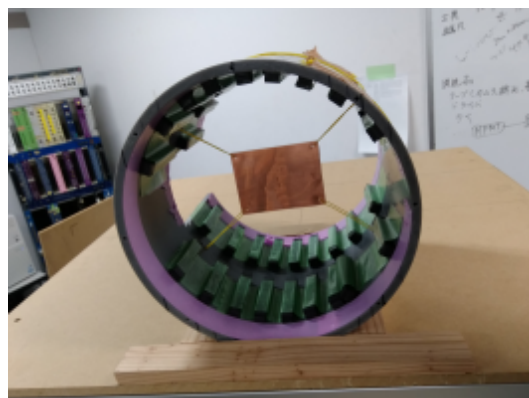
図 2.7 左は今回 \mu SR のために使用した磁石とその内枠. 中央に垂直方向に約 120 Gauss の一様磁場を発生させる. 右は昨年度使用した磁石 [16]. 中央の銅板の位置に垂直方向に約 60 Gauss の一様磁場を発生させる.
