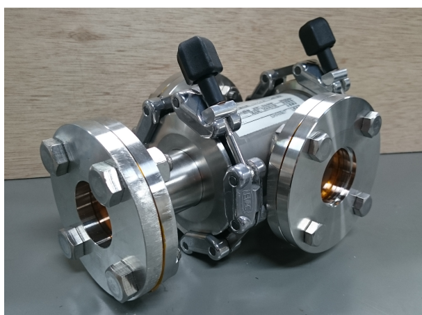
図 2.5 真空槽の外観.
