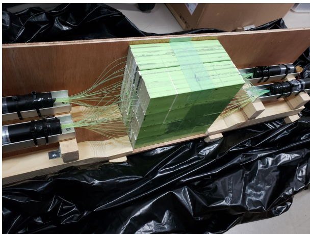
図 2.10 今年度使用したプラスチックシンチレータの 1 組分。シンチレータから光ファイバーを通して PMT で信号を読みだす。
