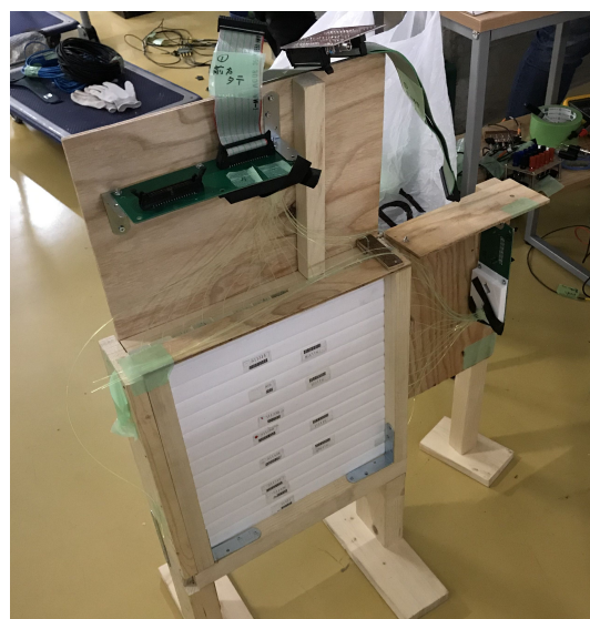
図 4.24 前方シンチ. ファイバー, クッキー, 治具, 平本ボード, フラットケーブルを繋げた状態.
