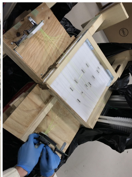
図 4.22 前方シンチにファイバー及びクッキーをセットしている最中. ファイバーが痛まないようにゴム手袋をし, 素手で触らないようにしている.
