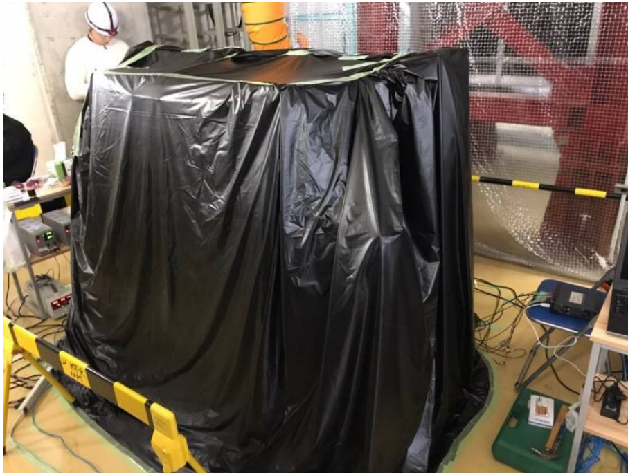
図 4.31 外からの光が測定の妨げとならないよう, 念入りに全体を暗幕で覆った.
