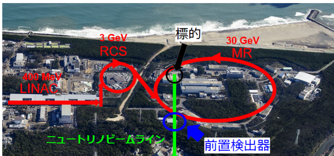
図 3.1 J-PARC の加速器群. 陽子を線形加速器とシンクロトロンをもちいて 30 GeV まで加速する. 30 GeV まで加速された陽子は炭素標的に入射し, パイオンの崩壊を経てニュートリノビームとなる.
