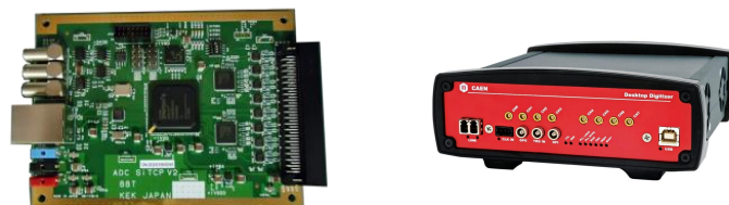
図 4.13 ADC の写真. 左が ADC-SiTCP, 右が CAEN 製 ADC.
