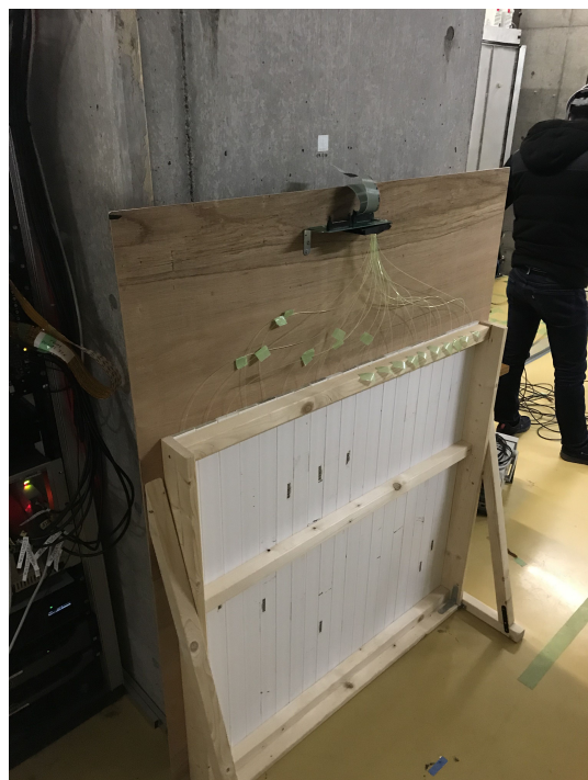
図 4.26 後方の縦 (鉛直方向). 構造上このパーツだけシンチの見える面がビーム方向と逆.
