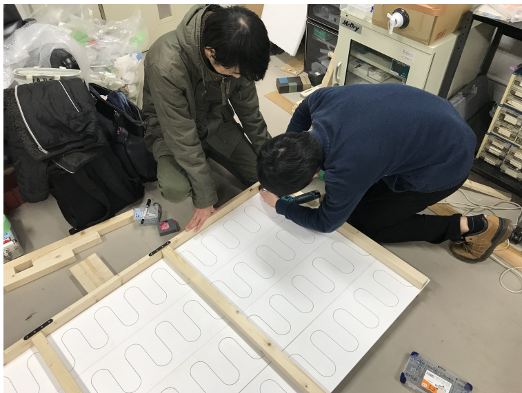
図 4.21 京都大学にて VETO シンチの木枠取り付け作業中.
