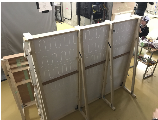
図 4.23 VETO シンチ. 木の境目で上下のパーツを分解できる.
