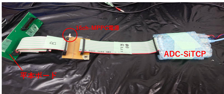
図 4.11 平本ボードから ADC までフラットケーブルを介してつながっている様子. 16ch-MPPC 電源と書かれてあるところに電源コードをつないで MPPC に電圧をかける.
