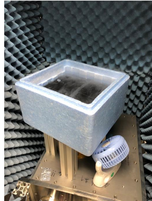
低温黒体による キャリブレーションの実際の様子
