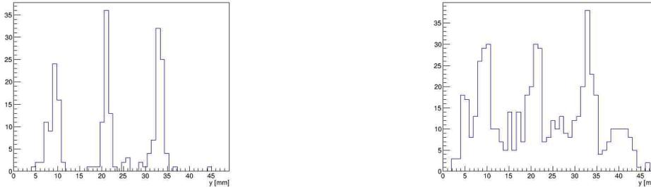
図 48: 中性子が検出された時刻の分布で一部の時間領域を切り取ったもの. 左が 34.56 ms から 34.58 ms, 右が 33.56 ms から 33.58 ms の区間を切り取っている.
