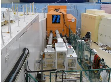
図 5: 3本に分岐した中性子ビーム. 左から低発散, 非偏極, 偏極ビームである.
