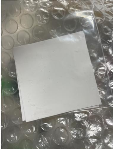
図 8: ZnS(<sup>6</sup>Li を添加) シンチレータ
