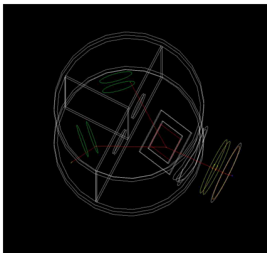
Møller 散乱したが全エネルギーをシンチレーターに落とさなかったイベント
