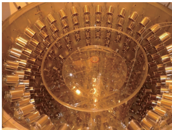
ダブルショー測定器の建設中の写真。液体シンチレーターを入れる二重アクリル容器と、その外側に設置された390本の光電子増倍管(磁気シールド筒に入っている)が見える。
