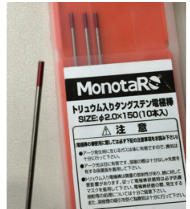
線源はタングステン電極棒に含まれている \alpha 線源( ^{232}\text{Th} )
