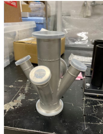
図 6.5 実際の配管の写真。入射光、反射光はこの配管側面の窓を通す。
