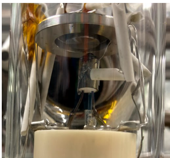
図 5.21 イオン源の直上およそ 5 mm の位置にファラデーカップを設置したセットアップ。イオン源-ファラデーカップ間の電場が前回より強力となる。真空中での運用時には気体の対流の危険がないため取扱の容易性から上下逆にしている。
