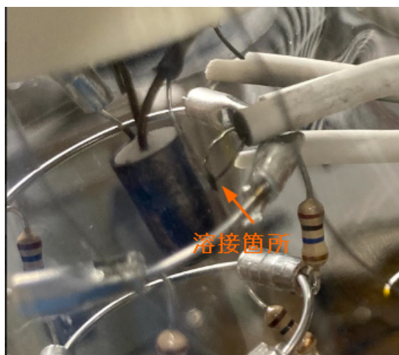
図 5.18 中央左にイオン源。イオン源右側に熱電対が溶接されている。フィールドケージの電極がステンレス線で構成されている。
