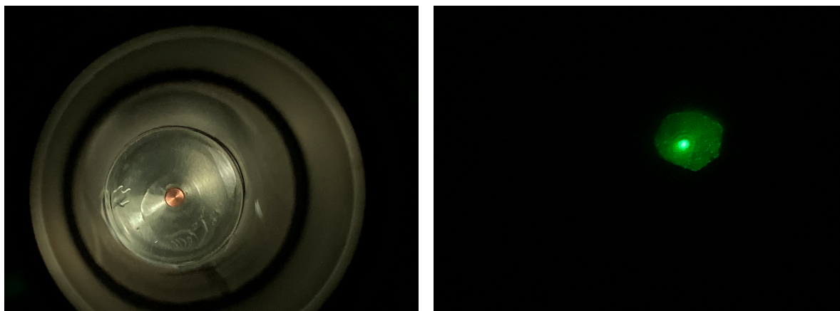
(a) チェンバー内の写真。液体・固体層が穴の外にも形成された。 (b) このときの反射光。銅電極からの反射でぼやけた成分に液面からの反射が乗っている。
