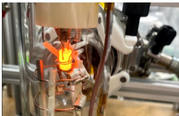
図 5.17 ステンレス線を用いてイオン源に熱電対をくくりつけ、イオン源を真空中で加熱した。イオン源は黒体輻射で赤い光を放出しているがステンレス線が影に見えている。この時点での熱電対の表示は約 900°C。
