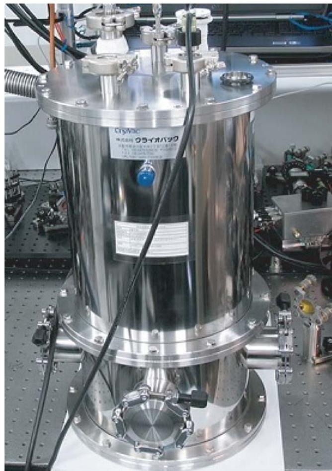
固体実験用セル (5 mm)
