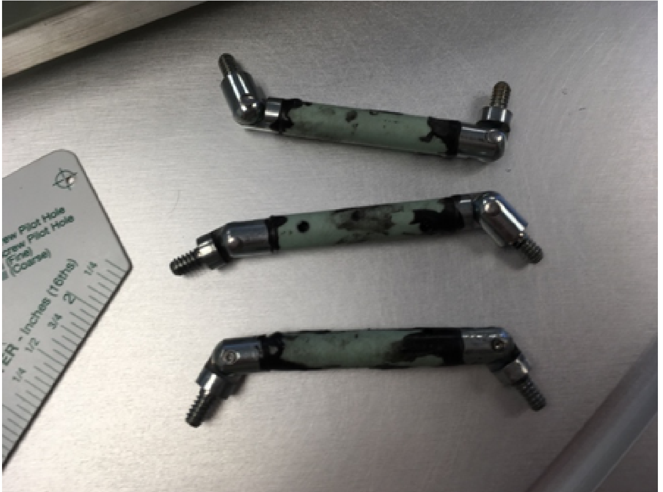
図 A.2 作成した部品. 断熱性の樹脂でできた円筒と, 力を滑らかに伝えるための蝶番関節を, 樹脂接着剤で接続した.
