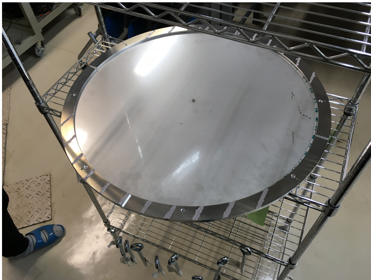
図 4.7 ワイヤー張りの作業。写真下部の小さな金属杭が重りであり、約 100g である。樹脂が固まるまで重りを吊るしたまま固定した。
