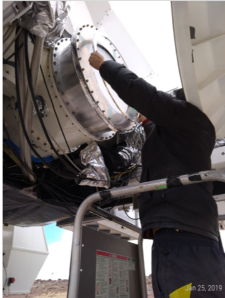
図 5.2 ワイヤを望遠鏡の眼前で回す。手などがある程度望遠鏡の視界に映り込むが、このノイズは無偏光の熱放射であるので、回転で変動する偏光信号と見分けることができる。
