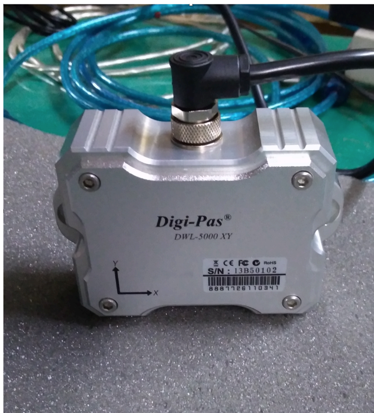
図 4.4 Digi-pas の角度計，DWL-5000 XY．ワイヤー治具の水平からの傾きを， 0.03^\circ の精度で測定する．
