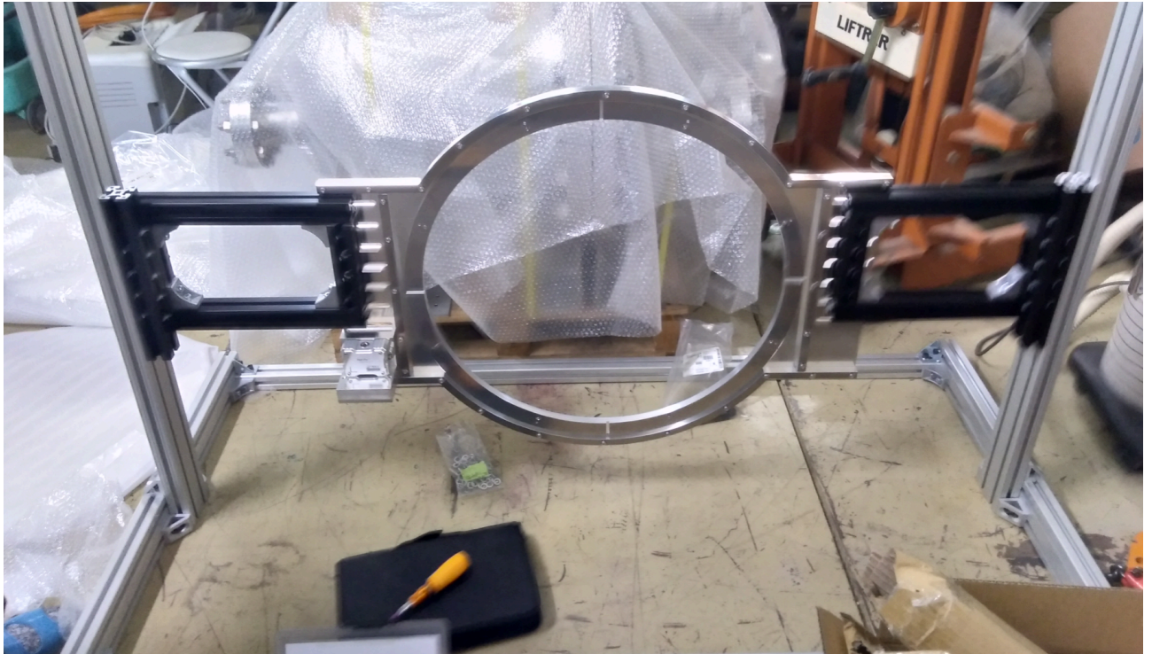
図 4.9 ワイヤーリングを望遠鏡の視野に固定する治具。リングとは位置ぎめピンによって組み合わされ、その際リングを回転させてつけることが可能になっている。
