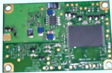
図 3.14 GPS 受信機 2 の写真。 ボード上の大きな黒いチップで情報 を処理している。
