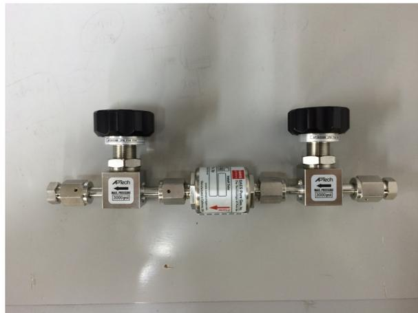
図 3.21: SAES マイクロトル精製機
