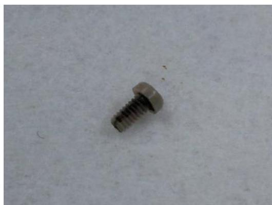
図 3.11: 放電によって焦げ付いたねじ
