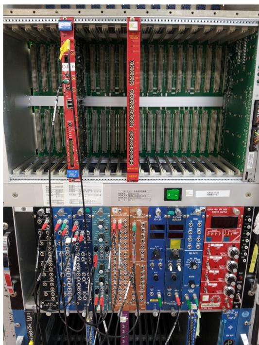
図 4.5: Flash ADC V1724 と NIM モジュール
