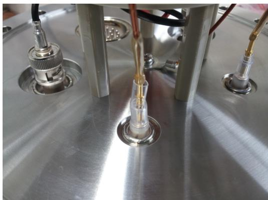
図 3.10: フィードスルーとピンコネクタをテフロン(半透明)、ピーク(薄茶色)の熱縮チューブで覆い、耐電圧を高める
