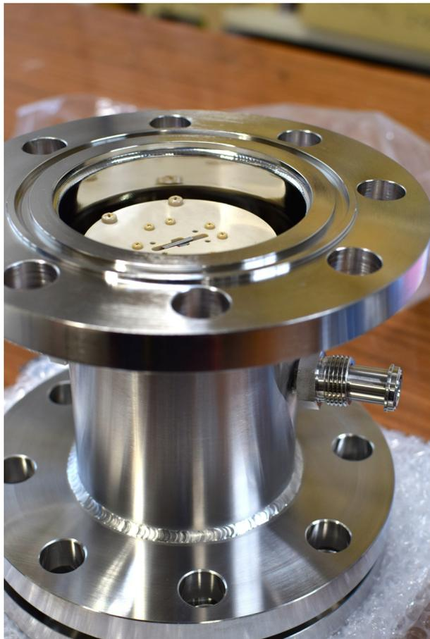
図 4.4: 圧力容器。ただし、トップフランジは外してある。また、ガス系への接続もされていない。
