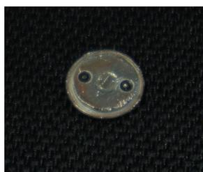
図 4.5: 今回用いた  $^{241}\text{Am}$  線源。中央の四角い領域に  $^{241}\text{Am}$  が蒸着されている。
