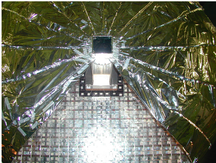
Fig. 3.5 実際の写真。中央の四角形がビームパイプ、奥が CsI、手前の銀色の部分が CV となっている。写真では後ろにある CsI が見えるように CV の下 1/4 が取り外されている。
