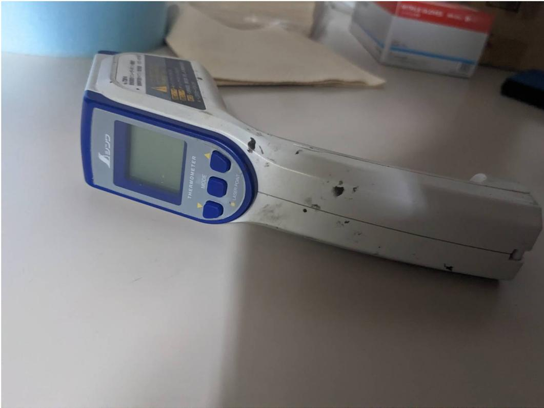
図 3.8: シンワ測定株式会社製の, 品番 73014 の温度計を用いて常温時の電波吸収体の温度を測定した. 常温を  $\pm 2^{\circ}\text{C}$  の精度で測定することができる.
