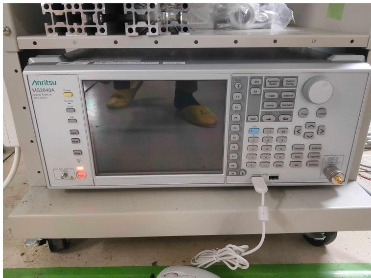
図 2.10: スペクトルアナライザを示す. アンリツ製の MS2840A.
