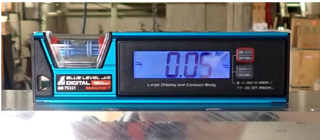
図 3.9: シンワ測定株式会社製の, 品番 75321 の水準器を用いて金属板のアンテナ開口部に対する傾きを測定した.  $0^{\circ}, 90^{\circ}$  の時  $\pm 0.1^{\circ}$  の精度で測定することができる.
