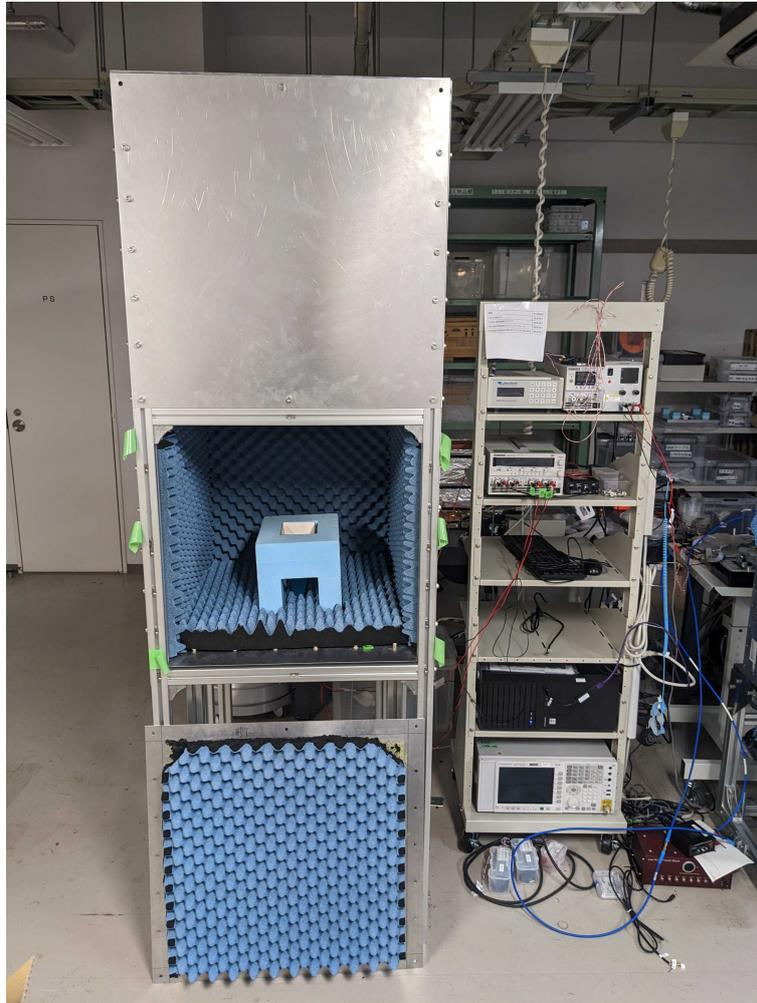
図 2.11: 実験セットアップ全体. 左側が暗箱で覆われた転換光発生用の金属板とホーンアンテナ. 青い発泡スチロールのところに上を向いたホーンアンテナが位置している. 実際の測定では手前の面も金属板+電波吸収体で覆われる. 右側が測定のためのアンプの電源やスペクトラムアナライザが置かれた 19 インチラック.
