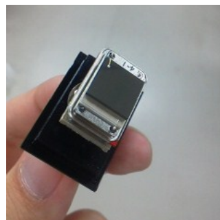
図 6.2 内部のショットキー型 CdTe 素子
