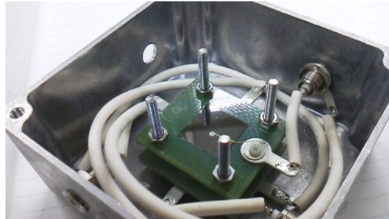
図 5.8 3枚積層させた CdTe 素子
