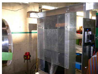
図 5.1 実験エリアに設置されたビームプロファイルモニター（前期セットアップ）。
