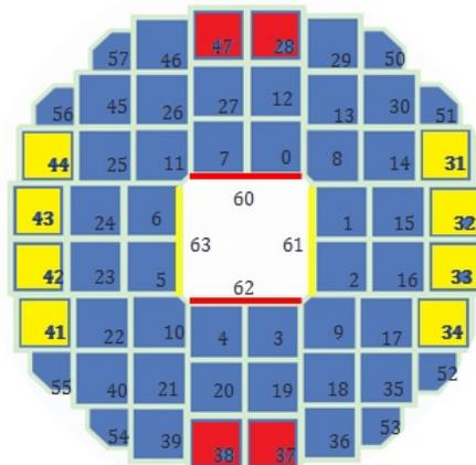
図 4.11 NCC 検出器を下流側から見た図。エネルギー較正に用いた module を色分けしてある。赤色が top, bottom とそのエネルギー較正に用いた NCC 結晶、黄色が north, south とそのエネルギー較正に用いた NCC 結晶である。
