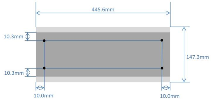
図 3.46 beam pipe を側面から見た図。色が薄い部分は斜めになっている面を、黒点は beam pipe に空けてあるネジ穴の配置を表す。ネジ穴は上下左右の面に全て同じ配置で空けてある。
