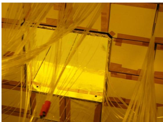
図 3.57 NCC beam pipe を上流から見た様子。beam pipe の内側に、銀色の反射材が巻かれた HINEMOS を確認することができる。
