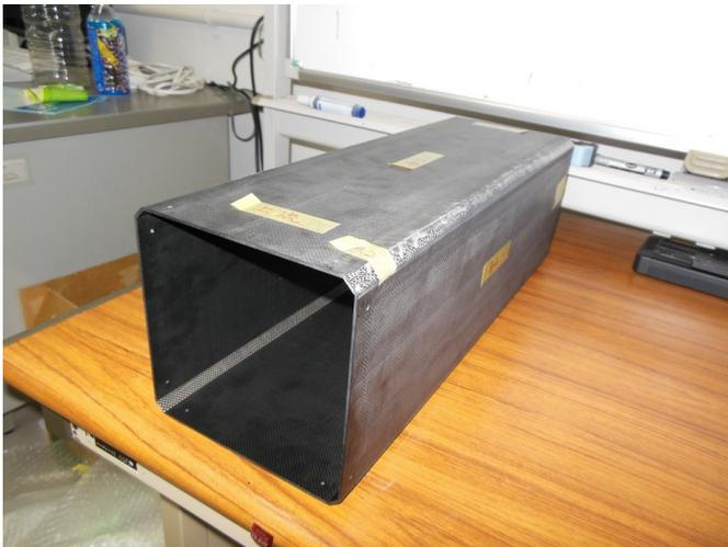
図 3.47 実際に使用した beam pipe の写真。上下流、上下左右を見分けるためのテープが貼られているが、構造は対称である。
