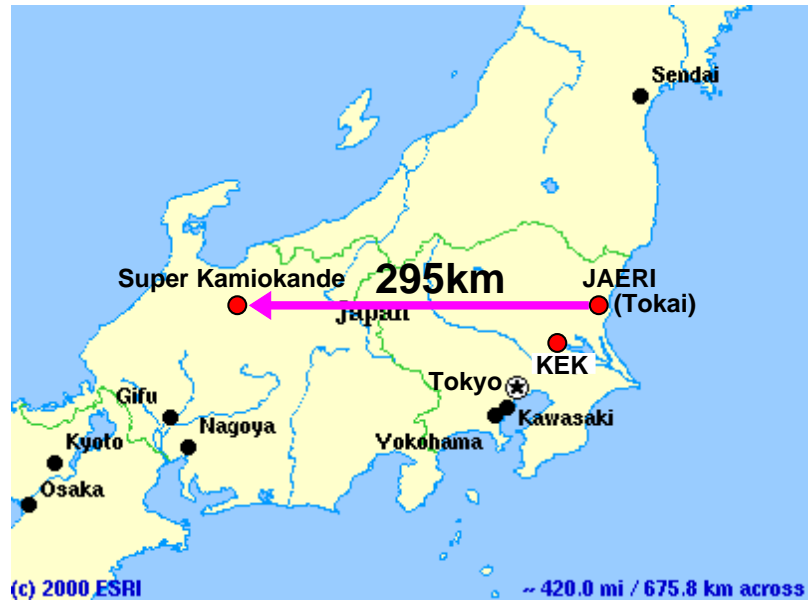
図 2.1: J-PARC ニュートリノ振動実験 (T2K 実験) の概観。T2K 実験は、茨城県東海村の大強度陽子加速器施設 J-PARC でニュートリノビームを生成し、295 km 離れたスーパーカミオカンデで検出する次期長基線ニュートリノ振動実験である。
