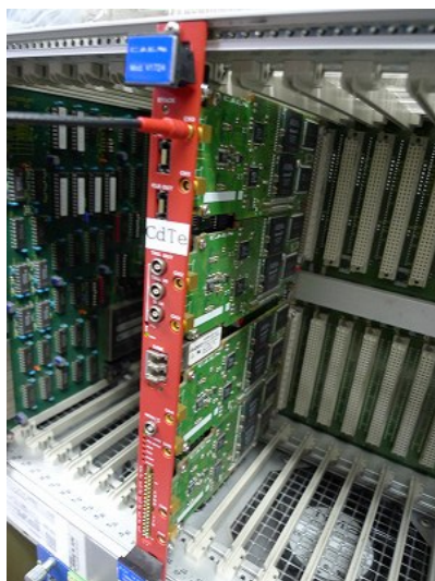
図 3.7: Flash ADC CAEN V1724
