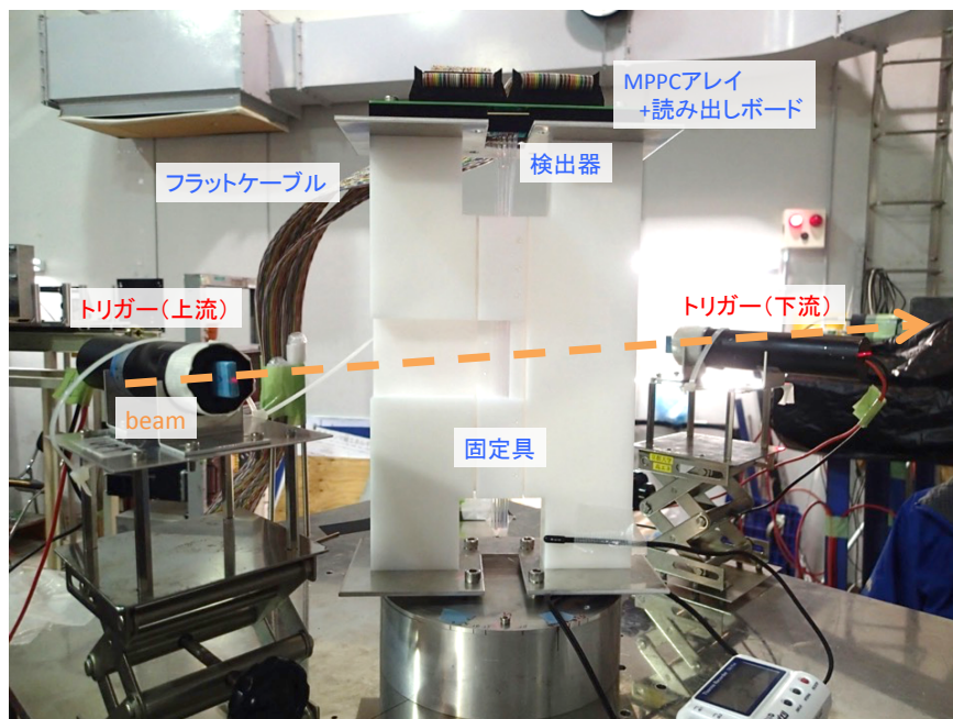
図 5.8: セットアップ写真: 縦置き。POM でできた固定具を用いて検出器全体を支えている。ビーム上流側で固定具にビームが当たらないような設計を行った
