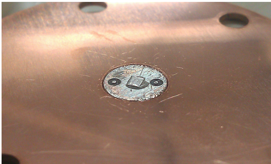
図 3.10: 線源とカソード。中心にあるのが ^{241}\text{Am} である。
