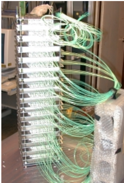
図 7.4: プロトタイプ飛跡検出器の飛跡検出器部分の組み立て完成写真。
