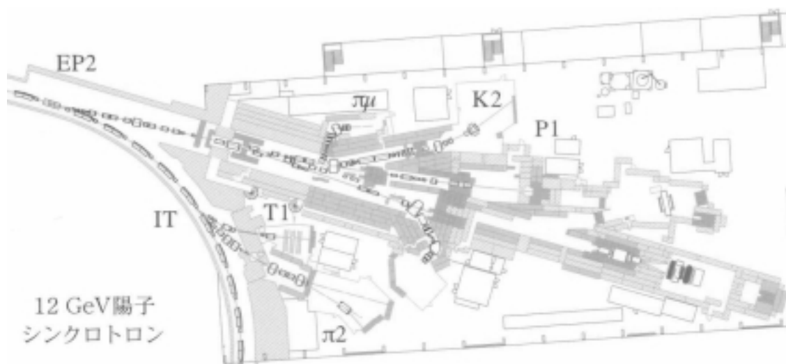
図 6.1: 高エネルギー加速器研究機構 12GeV 陽子シンクロトロン東カウンターホールのビームラインの概略図。T1 ビームラインは図中央左寄りにある。
