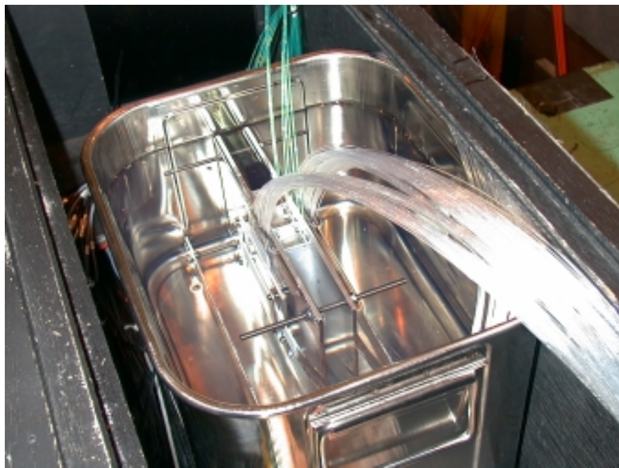
図 6.6: 光量測定用検出器の写真。
