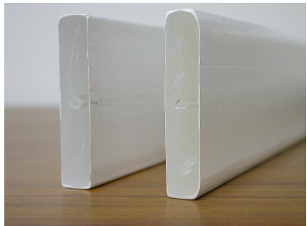
図 5.4: プロトタイプシンチレーターの実物。手前が SB、奥が SA タイプとなる。SB タイプの片面がややかまぼこ型になっている。
