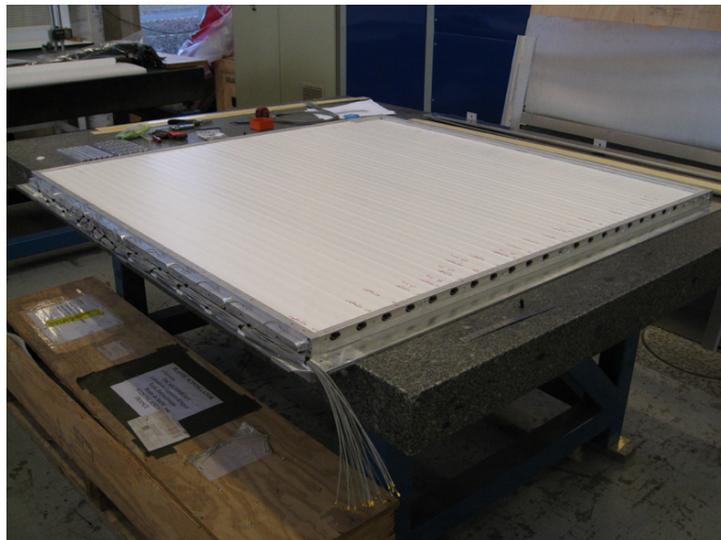
図 3.19: トラッキングプレーンのプロトタイプ。サポートストラクチャーまで含めて 80kg 近い重量がある。
