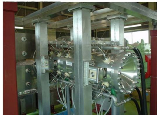
図 2.7: 第 1 電磁ホーン (プロトタイプ)
