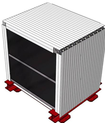
図 3.6: Veto カウンターまで取り付けたときのモジュールの完成予想図。Veto カウンターにもシンチレーターストリップの層を適用する。
