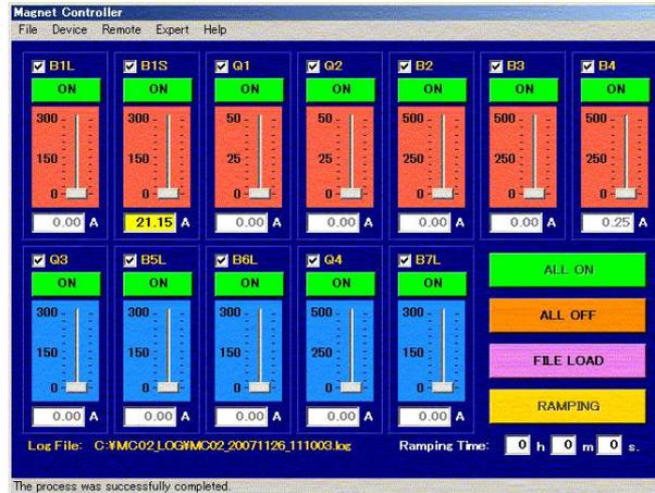
図 4.10: マグネットのコントロールモニター。図では B1L に直接電流値を指示している。
