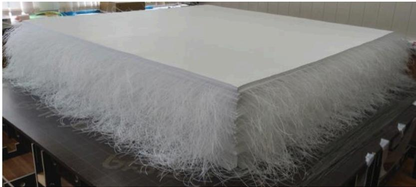
図 2.21: 釣り糸による SuperFGD の組み立ての様子。キューブに 2 方向から釣り糸を通してシート状に並べたものを重ねている。
