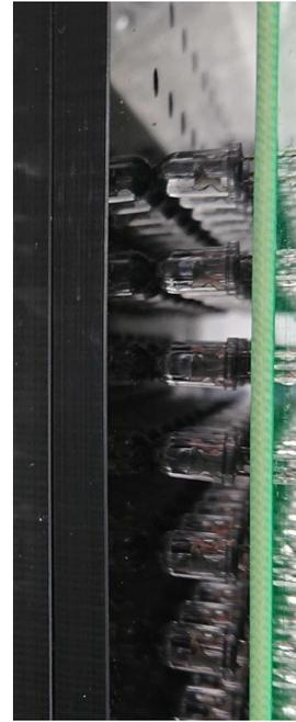
図 6.8: ファイバーを通さず測定した際のセットアップの様子。左図はプレートに紙を貼り付けた様子で、それを挟むようにして MPPC を取り付けた。右図は LED の頭をプレートの穴に押し当てて位置を決めている様子である。
