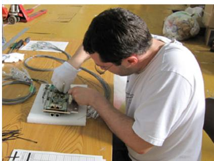
図 8.6 TFB へのケーブルの取り付け
