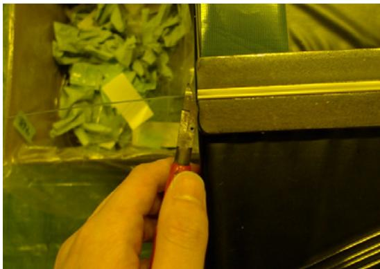
図 E.4 ファイバーの必要な長さへの切断
