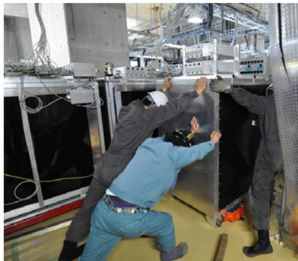
図 8.48 Proton Module のインストール作業
