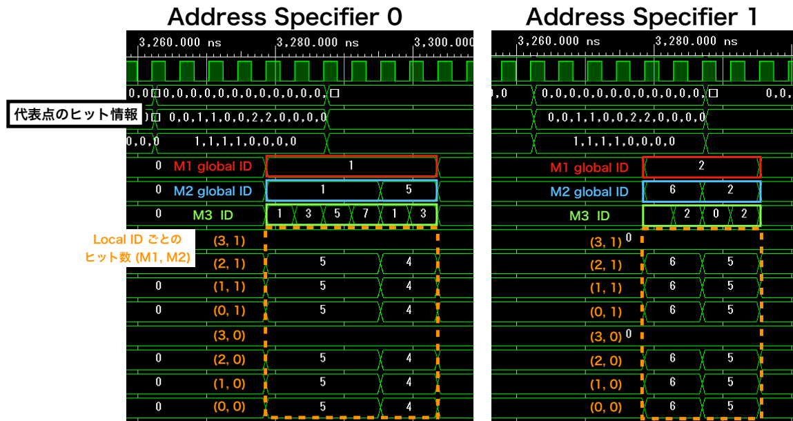
図 7.25 : Address Specifier の回路シミュレーション. それぞれで表 7.2 に示す優先順位に従って UltraRAM への入力アドレスとヒット数を最大 6 組出力している.
