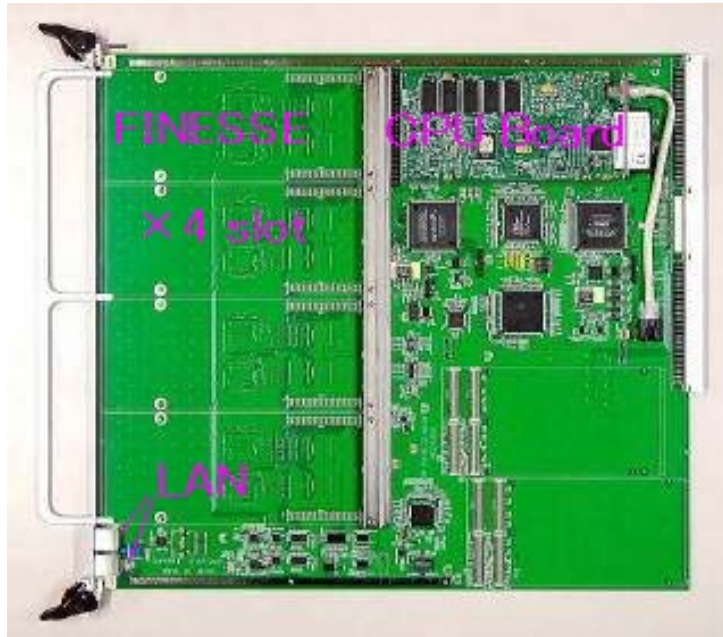
図 2.16 親ボード COPPER、前面に 4 つの子ボード (FINESSE) を挿入するスロットを有する。
