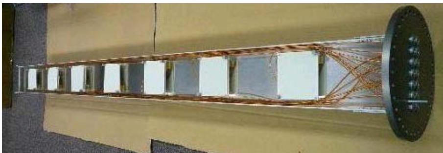
図 2.4 過去に製作した平行平板型イオンチェンバー試作機内部の写真。
