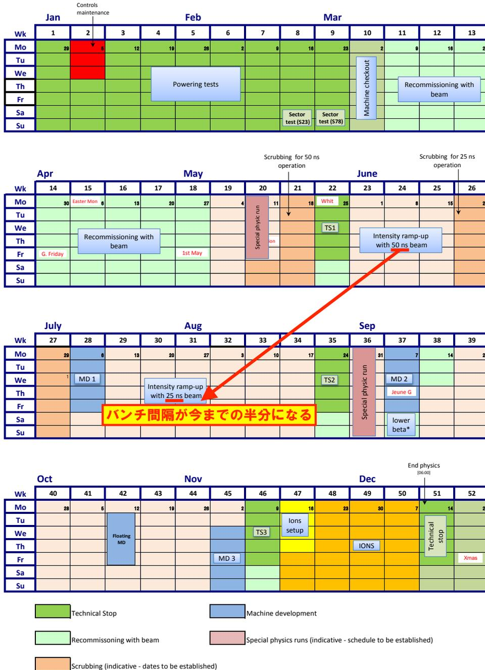
図 2.2: 2015 年 LHC の運転スケジュール。8 月にバンチ間隔を 25 ns にする。
