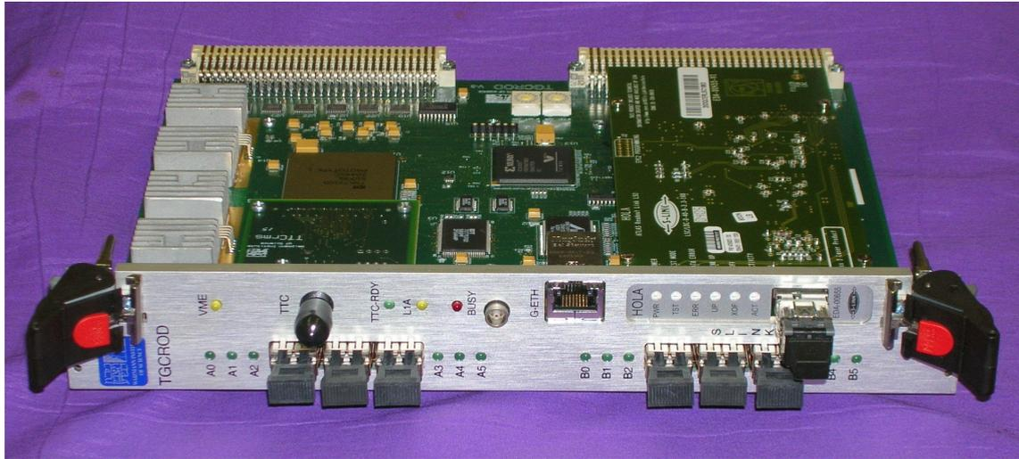
図 3.14: ROD の写真。SSW から圧縮されたデータを受け取り、出力フォーマットに従って ROS へと送信する。
