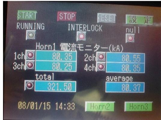
図 49: 動作モード・合計電流異常時画面 図 50: 動作モード・null 電流異常時画面
