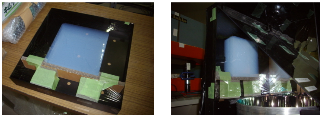
図 4.3: エアロジェル発光量測定に於けるエアロジェルのインストールの様子. 左のように 30cm 角のアルミ製の箱にエアロジェルを配置し、このボックスを右図のようにモジュールに挿入する.
