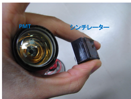
図 3.13 ビームプロファイル測定用シンチレーターカウンター。INGRID シンチレーターを削ったものを PMT で読みだした。
