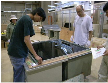
図 A.6 遮光ゴム接着の後に、遮光板を設置する。
