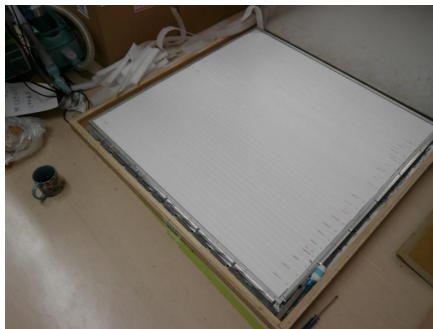
図 3.12 トラッキングプレーンフレームのプロトタイプ。実機とほぼ同じであるが、側面の遮光用プラスチック板のかわりにアルミニウム板が用いた。
