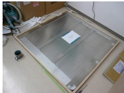
図 3.12 トラッキングプレーンフレームのプロトタイプ。実機とほぼ同じであるが、側面の遮光用プラスチック板のかわりにアルミニウム板が用いた。
