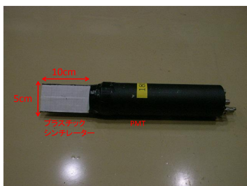
図 3.6 トリガーカウンター。プラスチックシンチレータの断面積は 5cm×5cm である。
