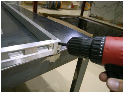
図 A.2 4本のアルミバーは4つの頂点で2本のM4 × 12ネジで固定される。全てのネジ締めは電動ドライバー(リョービBD-70)によってトルク管理している(約1.0N・m)。
