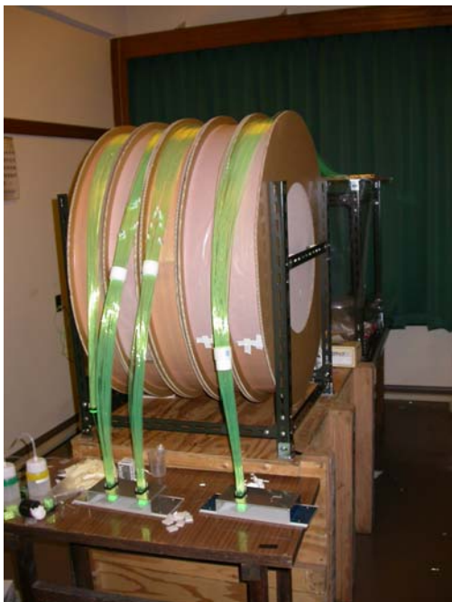
図 C.2: 波長変換ファイバーを cookie に接着しているところ。ファイバーの先端に見える黒い固まりが cookie である。
