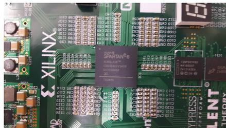
図 3.2: FPGA の評価ボード (上) とそれに搭載されている FPGA のチップ (下)。写真は Digilent 社の nexys 3 ボードと FPGA は xilinx 社の Spartan6
