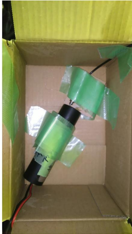
図 4.5: モニター PMT のセットアップ。段ボールに
