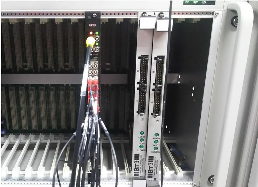
図 5.2: veto module をハット 3 で設置した写真。赤いランプがついているところが veto の出力で、セントラルハットに veto 信号を送っている。下の赤い LEMO ケーブルは、SN module からの SN トリガーであり、合計 12 本つながっている。
