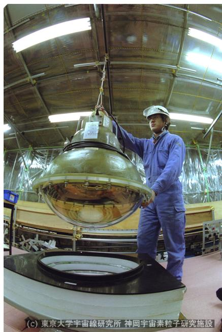
図 2.9: 取り付け作業中の PMT。アクリルカバーと FRP の保護ケースに覆われている [11]。
