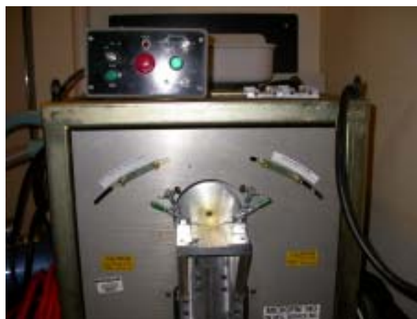
図 A.2: Polisher の写真。ダイヤモンドカッターを用いて端面を処理できる。
