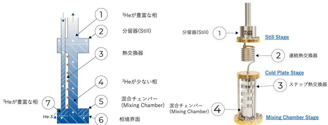
(a) 希釈冷凍機の動作原理 [22]。 ^3\text{He} と ^4\text{He} の (b) 希釈冷凍機の構造 [22]。分留器 (Still)、二混合状態において、極低温で ^3\text{He} が豊富な相と ^3\text{He} が少ない相 (残りは超流動 ^4\text{He} ) に分離する。混合チェンバー (Mixing Chamber) の位置にそれぞれス性質を利用する。2 相の間を ^3\text{He} が移動する際 テージがある。の潜熱を利用して冷却能力能力を得ている。
