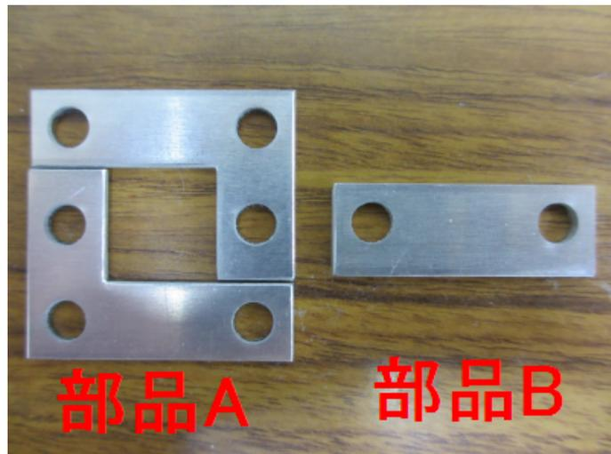
図 4.16: ファイバー固定用クッキーに Monolithic MPPC array を固定する部品
