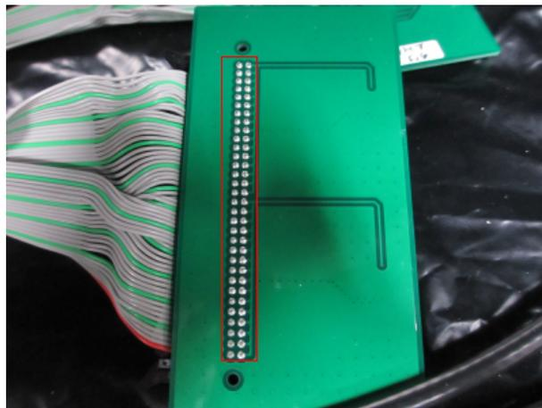
図 5.1: Monolithic MPPC array, EASIROC ボード間の回路の裏
