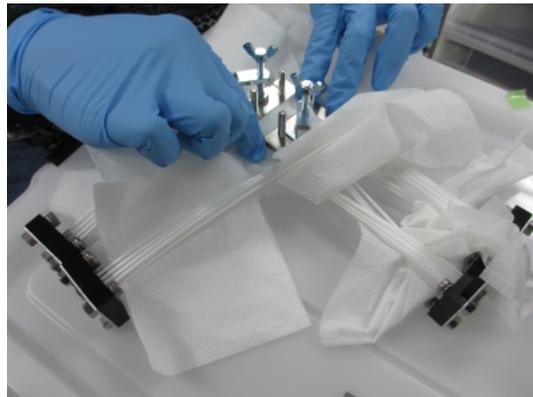
図 4.19: プロトタイプ検出器の組み立て作業中の様子
