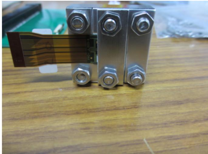
図 4.17: ファイバー固定用クッキーと Monolithic MPPC array を接続したところ
