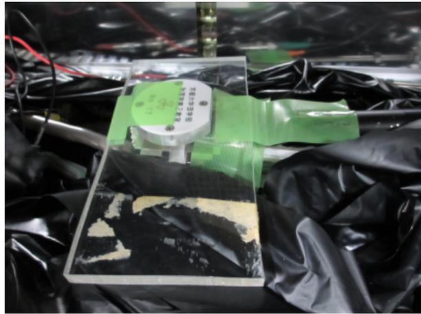
図 5.14:  $^{90}\text{Sr}$  線源を用いたプロトタイプ検出器の試験の様子。検出器の上にトリガー用のシンチレータ、その上にアクリル板、その上に Sr 線源を設置した
