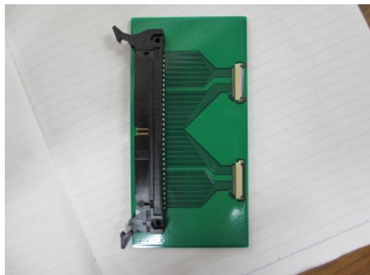
図 4.4: Monolithic MPPC array と EASIROC ボード間のコネクタ変換回路
