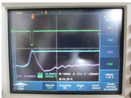
図 4.8: EASIROC ボードの slow shaper 後の信号 (紫)、HOLD 信号 (緑)、HOLD 後の信号 (青) : 波高検出型
