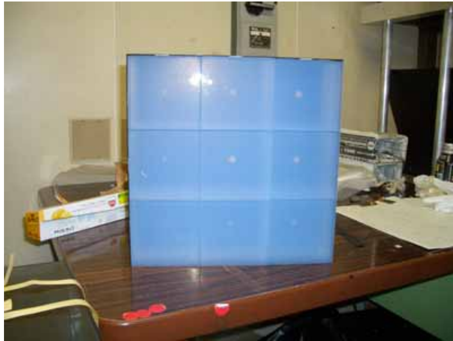
図 3.43: エアロジェルタイルの継目。白っぽく見えており、ここで光が散乱されていることがわかる。
