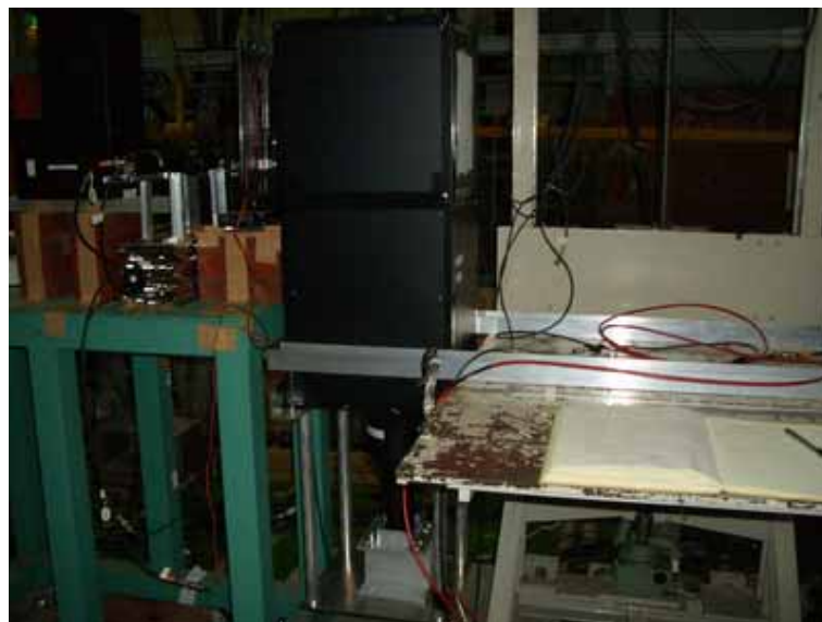
図 3.19: プロトタイプモジュールの設置の様子。中央にあるのがプロトタイプモジュールであり、その右にある白い台が、XY 方向に移動可能な自動ステージである。ビームラインの高さにモジュールの感度領域を合わせるため、自動ステージにチャンネル材を渡し、そこからモジュールを吊り下げるといった方式をとった。
