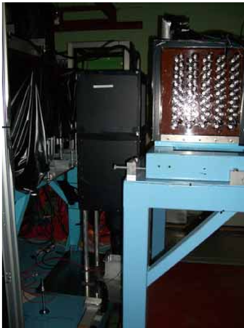
図 4.8: E391a 検出器へ組み込んだ写真。左側が上流であり、中央にあるのが APC、左にあるのが BHCV、右にあるのが BA である。APC は万力により、下にある青い架台に固定されている。また、この時点では BA のシグナルおよび HV ケーブルは接続されておらず、BA のコネクタが見えている。
