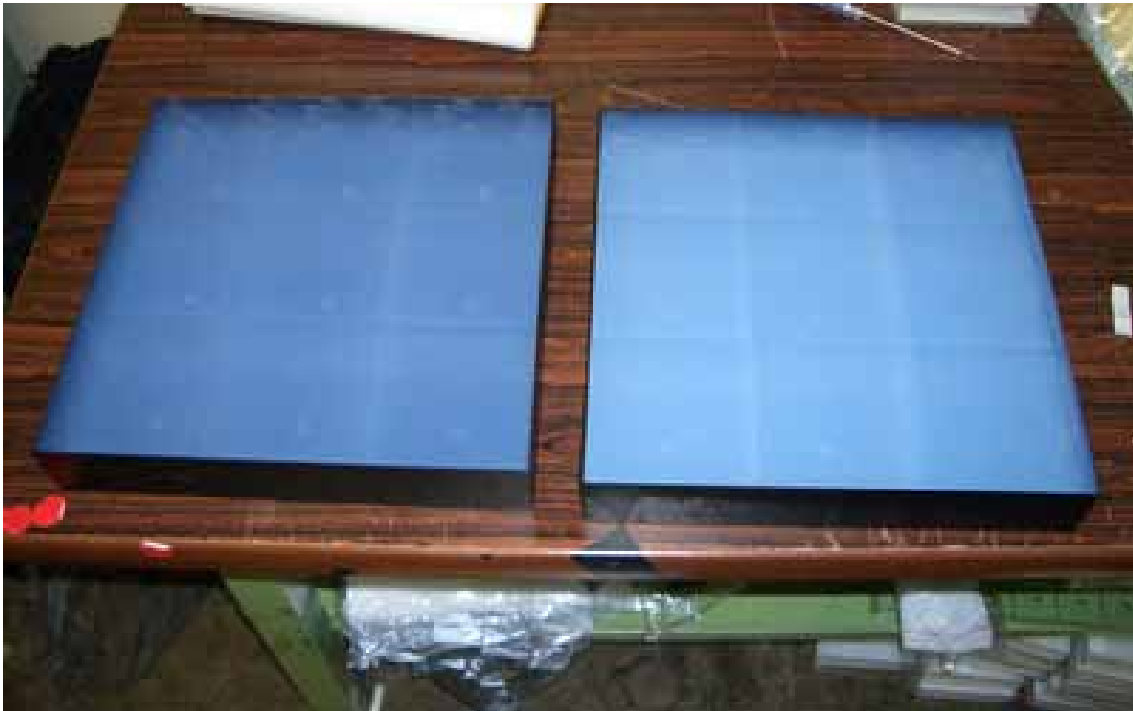
図 3.3: エアロジェルタイルの写真。モジュールに挿入用の箱に詰めた状態であり、左が屈折率 1.03 の YI30、右が屈折率 1.05 の YI50 である。一般に屈折率が高いほど透過率は低くなる。このため YI50 の方が写真では白っぽく見えている。この後、サランラップを壁の無い面全体に張ることでエアロジェルを固定し、モジュールにインストールした。
