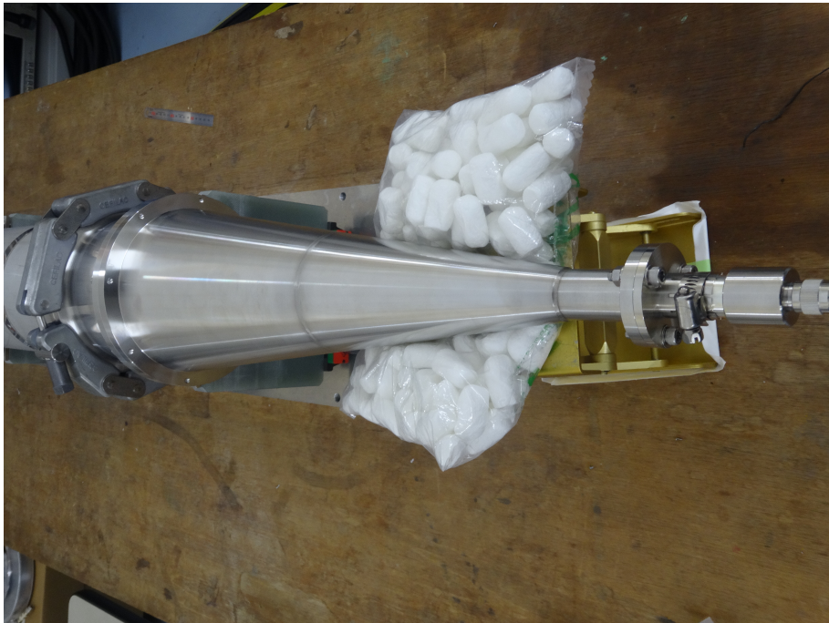
図 D.1: 製作したテーパー管の写真
