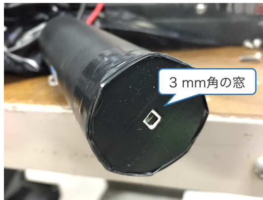
図 3.9: カバーを取り付けた PMT の受光面。
