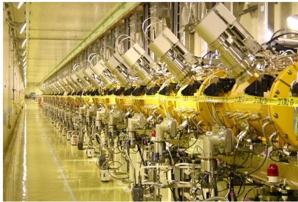
図 3.6: J-PARC Linac DTL の様子 [30]
